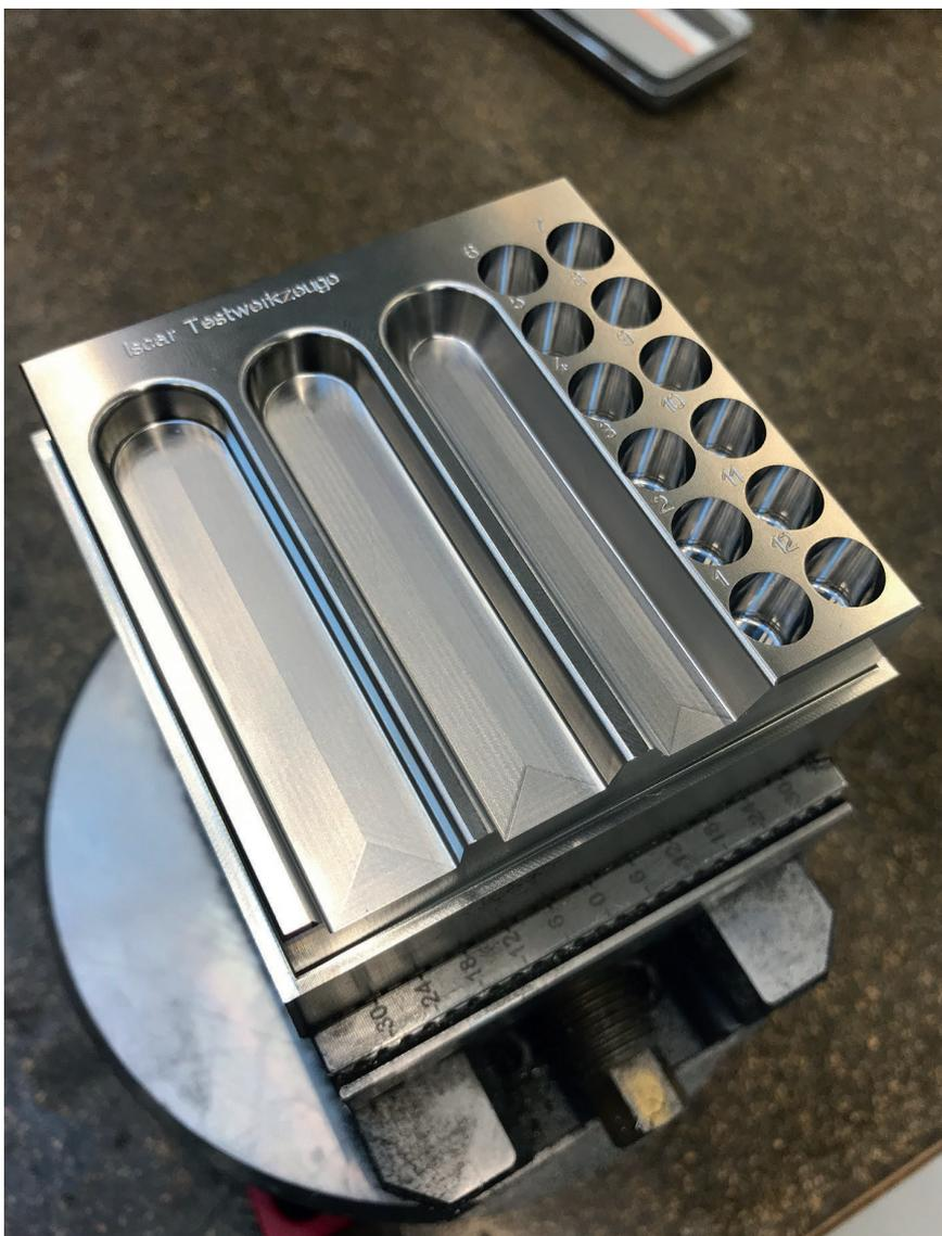
**Leistungsbeweis erbracht:** Bei Praxistests in 1.2379, durchgehärtet auf 60 HRC, konnten die Mini-Fräser von Iscar für die Hartbearbeitung überzeugen © Iscar
